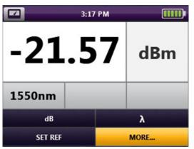
Fig. 21: Power Meter Controls
