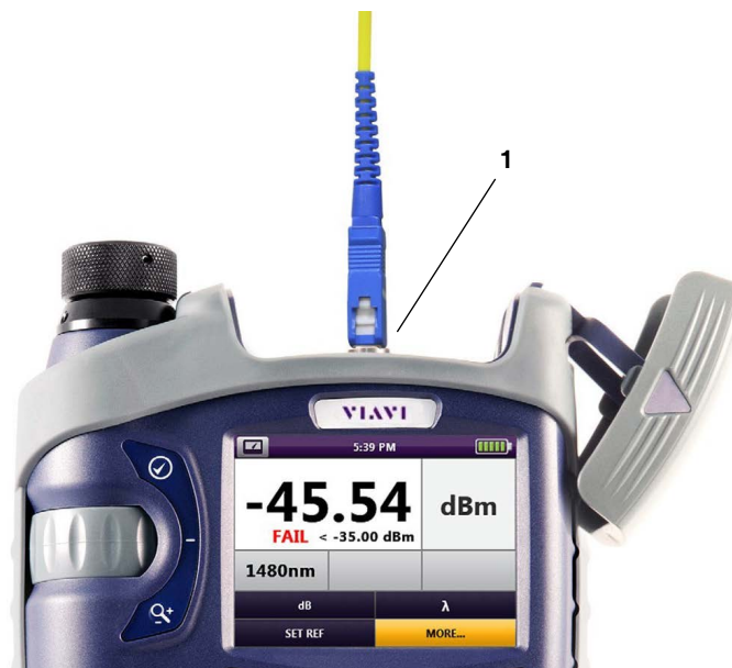
Fig. 20: UPP Power Meter Input
