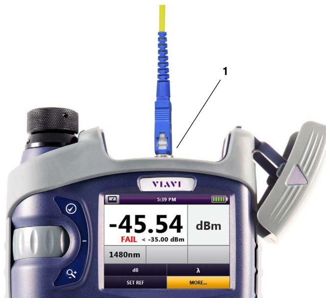
Fig. 20: UPP Power Meter Input
